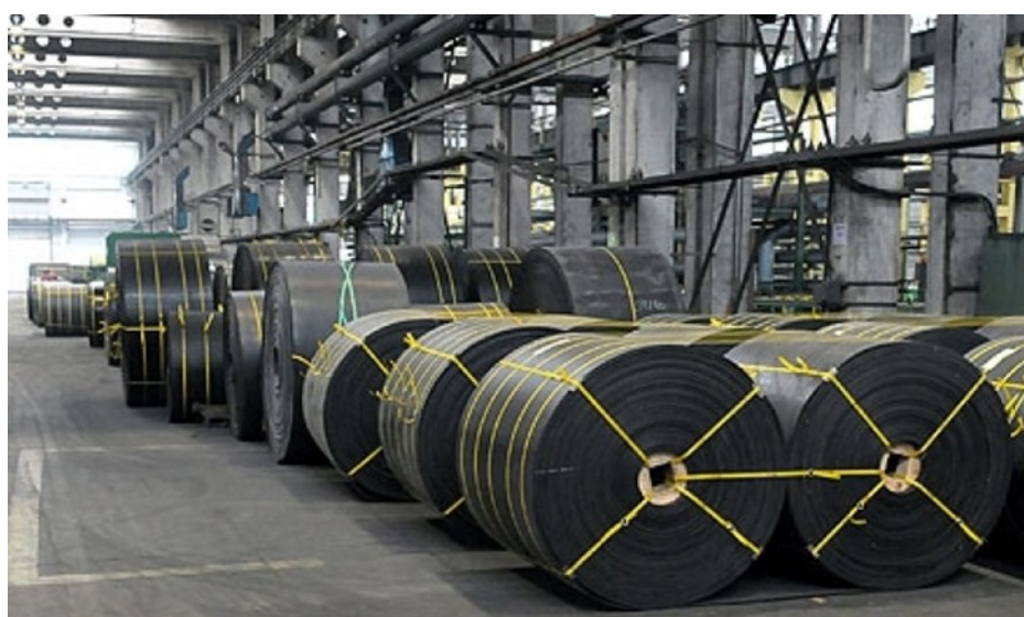
Rys. 1.2 Baloty taśm transportowych ze rdzeniem tkaninowym
