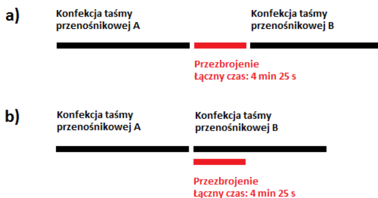
Rys. 1.4 Przekształcenie przebrojenia wewnętrznego w zewnętrzne
