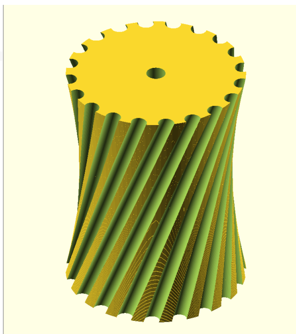
Obr. 3 Jednodílný hyperboloid jako část převodovky
